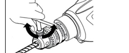
Для установки сверла, вставьте его до упора в зажимной патрон.
