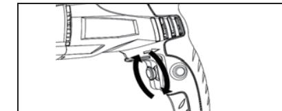
Alet, açma-kapama düğmesine (9) uygulanan baskı gücüne göre 0 ile maksimum değişken hız değerleri aralığında çalışır.
