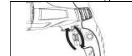
Машини працює зі змінною швидкістю від мінімальної до максимальної залежно від тиску на вимикач вимикання/вимикання.
