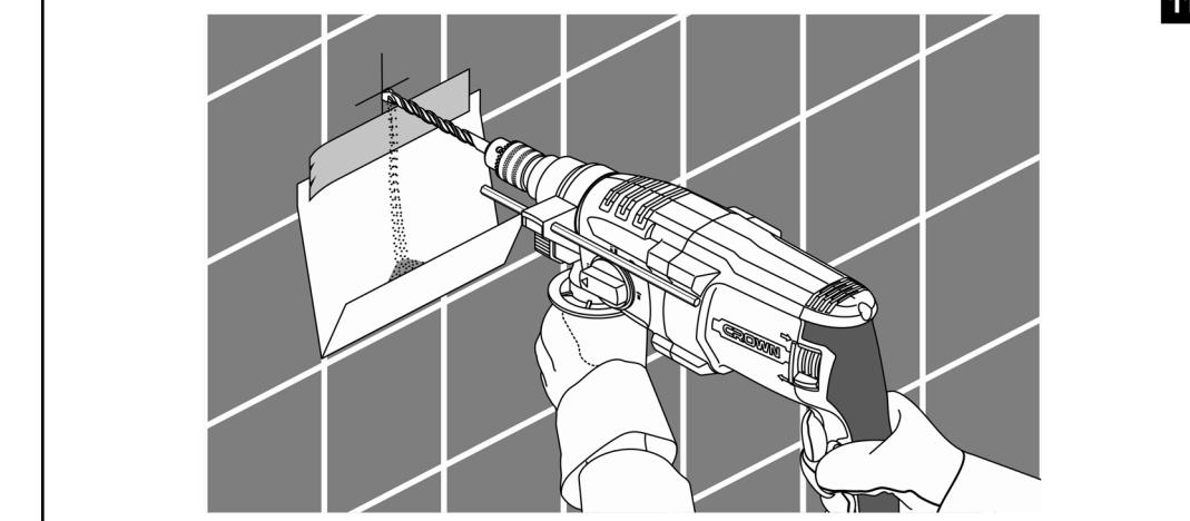
• ركّب المحول رقم 14 (SDS PLUS) في المقبس رقم 1 (PLUS) واحرص على تكرار نفس الخطوات عند تركيب المقبس (الأزميل) كما هو موضح في الشكل رقم 6.
